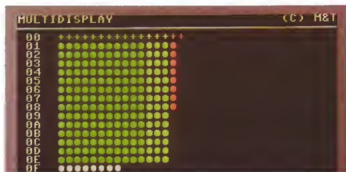
[2] Das Programm zu Multidisplay zeigt 16 Balken, die den Eingangsspannungen entsprechen
